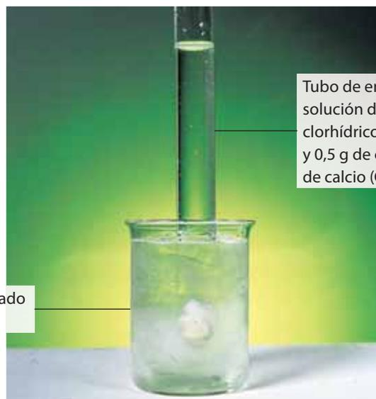
Tubo de ensayo con solución de ácido clorhídrico ( $\text{HCl}_{(\text{ac})}$ ) y 0,5 g de carbonato de calcio ( $\text{CaCO}_3$ )
