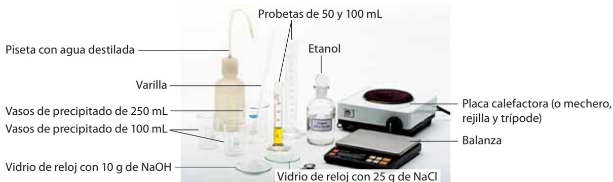
**A** Preparen 40 mL de una solución acuosa de etanol al 50% V/V en un vaso de precipitado de 100 mL y 100 mL de una solución acuosa de NaCl al 30 %m/V en un vaso de precipitado de 250 mL.
